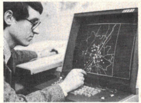
Afb. 1. Het nieuwe interactieve grafische systeem IGS van Siemens kan – bijvoorbeeld in een formatiesysteem voor ruimtelijke ordening – helpen de beschikbare informatie over leeftijdsopbouw, woondichtheid, scholen in een bepaald gebied snel, overzichtelijk en in willekeurige varianten op het beeldscherm weer te geven. De foto laat onderzoek van infrastructuurvoor-zieningen met steun van IGS zien.
